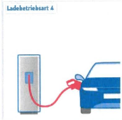
Die Ladebetriebsart 4 ist für das Laden mit Gleichstrom (DC-Laden) an fest installierten Ladestationen vorgesehen. Die Ladeleitung ist immer an den Ladestationen fest angeschlossen. Im Gegensatz zu den anderen Ladebetriebsarten ist bei dieser das Ladegerät in der Ladestation integriert, welche auch die Sicherheitsfunktionalitäten umfasst. Die Kommunikation zwischen Ladestation und Fahrzeug erfolgt über die Ladeleitung. Darüber hinaus erfolgt die Verriegelung des Steckverbinders.
